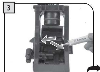
Направляющие блока смазывать только смазкой, поставляемой в оснастке.
