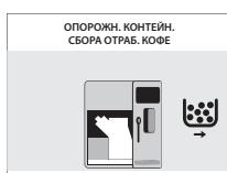
Вынуть контейнер для сбора отходов и очистить его от отходов в подходящий контейнер. **Примечание: контейнер для сбора отходов должен быть освобожден только тогда, когда машина запрашивает об этом, и при выключенном машине. Освобождение контейнера для сбора отходов при выключенном машине не позволяет машине регистрировать выполненное освобождение.**
