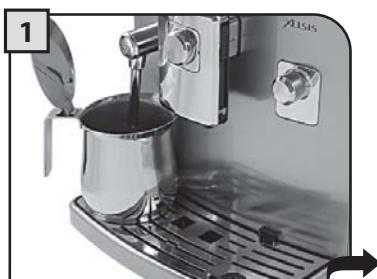
Установить какую-либо емкость под трубкой пара/горячей воды.
