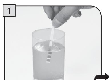
На 1 секунду погрузить в воду пробный образец для тестов жесткости воды, имеющихся в машине.
