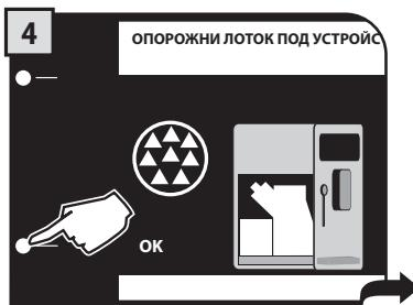
Освободить лоток каплесборник, находящийся под блоком (стр. 44 - рис.2) и вставить его на место. Затем нажать на "OK".
