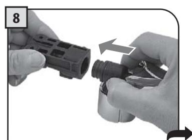
Снять треугольный внешний штуцер.
