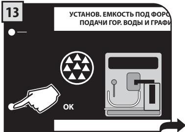
Расположить емкость под устройством подачи и емкость под трубкой горячей воды. Затем нажать на "OK".
