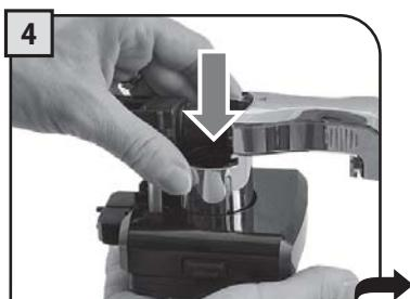
Вставить только что установленный блок на основание крышки. Обращать внимание на отметку.
