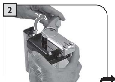
Повернуть по часовой стрелке ручку для отсоединения узла.
