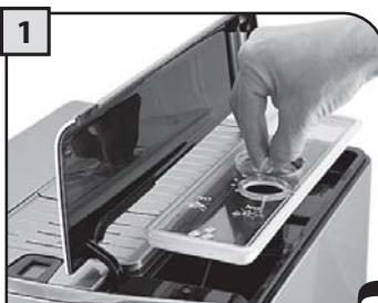
Приподнять нижнюю правую крышку и удалить внутреннюю крышку.
