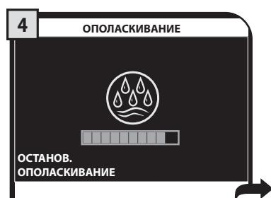
По окончании подогрева машина выполнит цикл ополаскивания внутренних контуров. Цикл можно прервать, нажав на кнопку "ОСТАНОВ. ОПОЛАСКИВАНИЕ".
